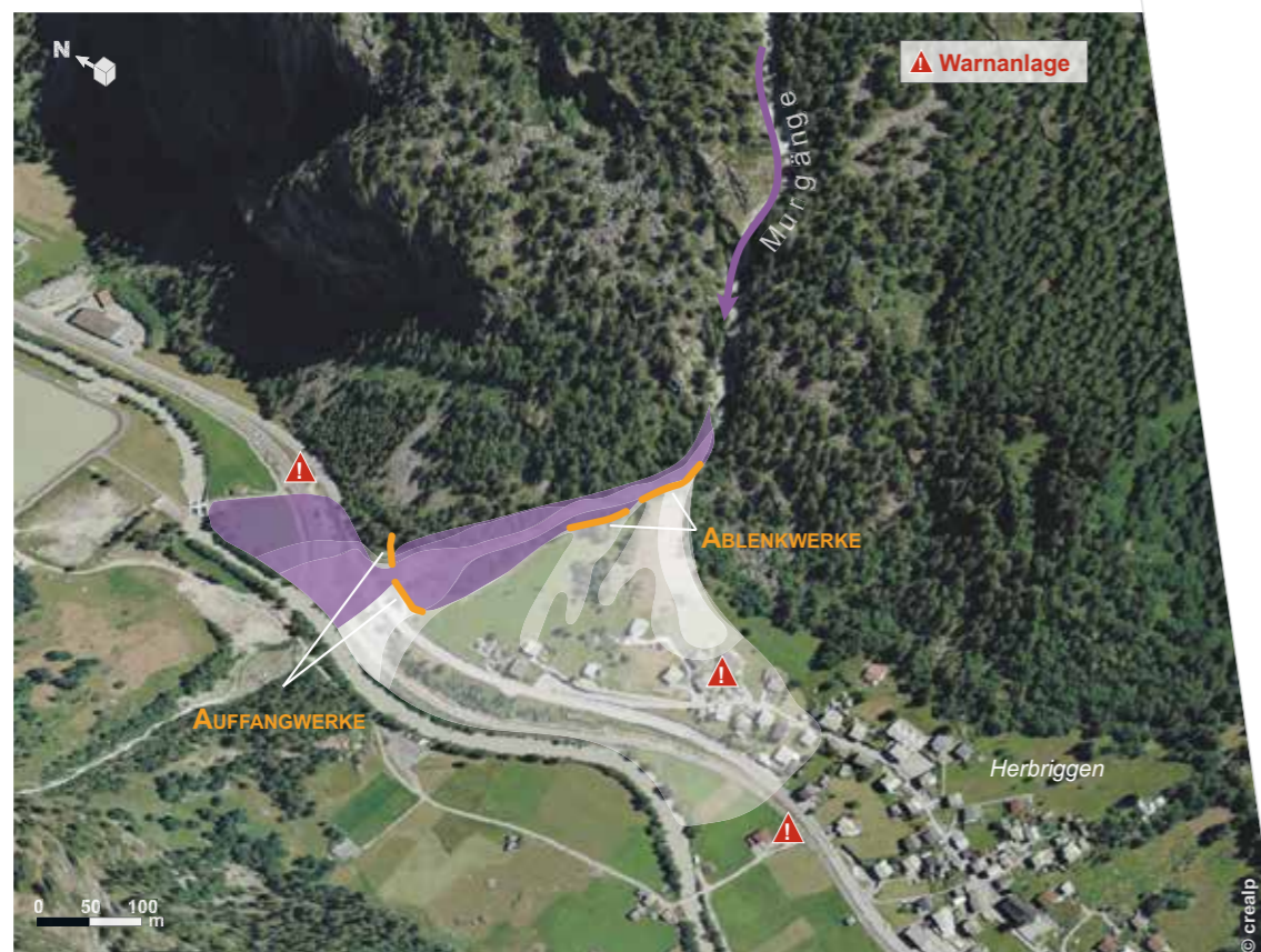
Wirkung der Massnahmen für das Szenario «300-jährliches Ereignis». Weiss = ohne Massnahmen von Murgängen betroffene Zone; farbig = betroffene Zone nach Umsetzung der Massnahmen.
